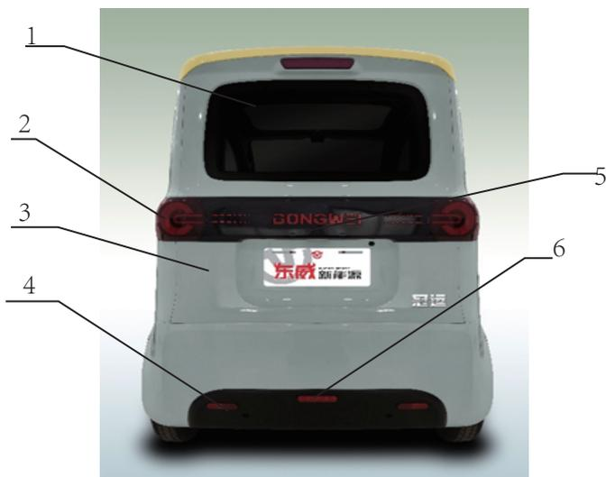
1、后窗玻璃 2、尾灯 3、后护板 4、后反射器 5、牌照灯 6、雾灯
