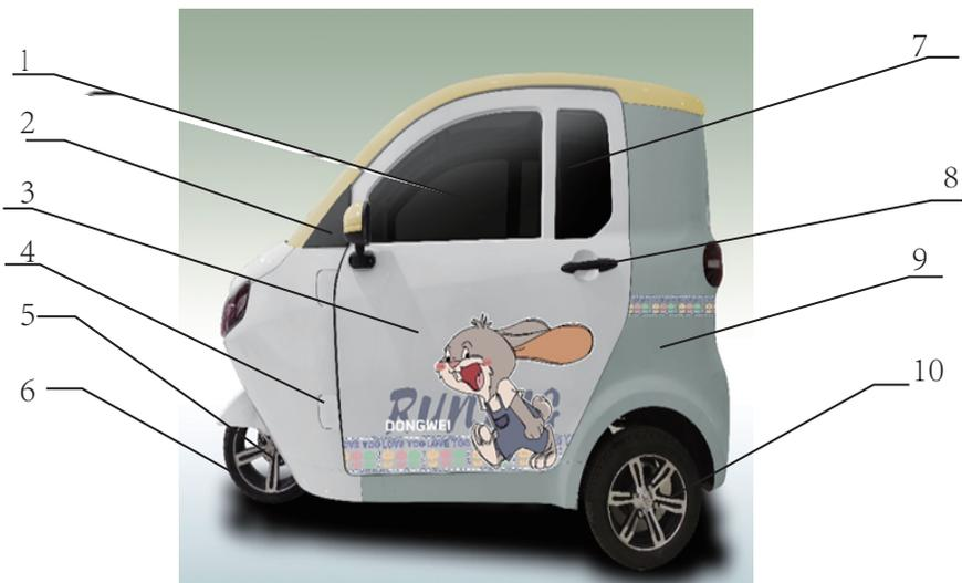
1、车窗玻璃 2、前三角玻璃 3、车门 4、合页 5、前减震 6、前轮 7、后三角玻璃 8、车门锁 9、后保险杠 10、后轮
